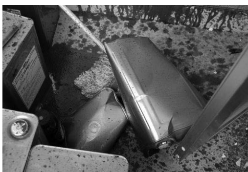
写真2 破裂し、底の抜けた缶
