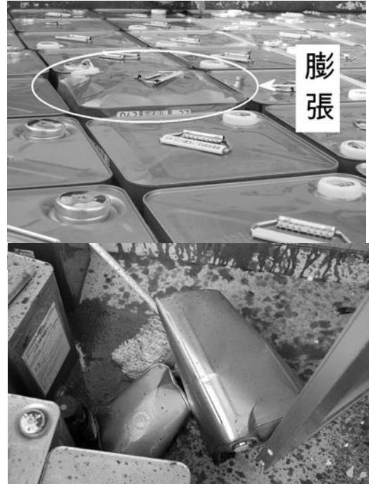
写真2 破裂し、底の抜けた缶
