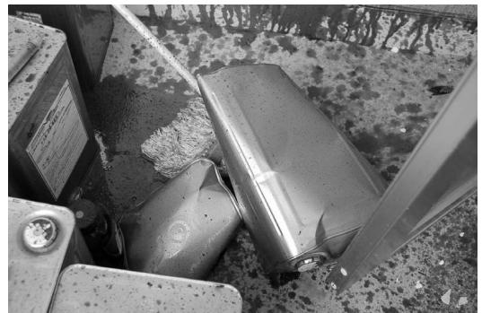
写真 2 破裂し、底の抜けた缶
