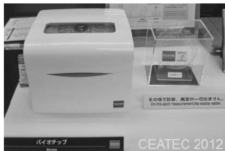
図8 唾液ストレス計測用μASプロト機
