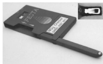
図 5 試作硝酸イオン FET センサ
