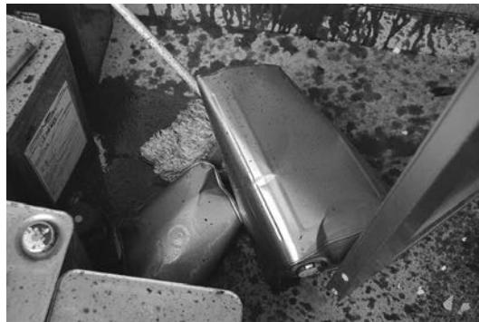
写真 2 破裂し、底の抜けた缶
