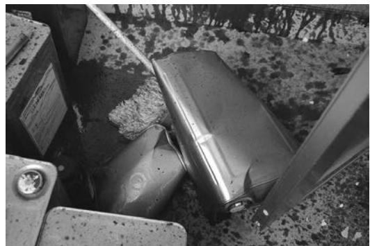
写真2 破裂し、底の抜けた缶
