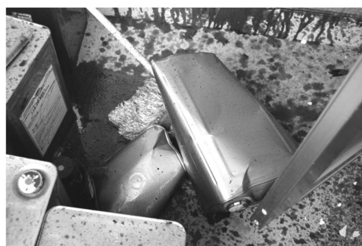
写真 2 破裂し、底の抜けた缶
